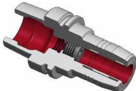
**Utilisation:** Serrage de haute précision des outils de fraisage selon DIN 6535 forme HA, HB, HE. Manche d'outil selon DIN 1835 forme A, B avec tolérance de tige h6 et Ra de 0,3 mm.
