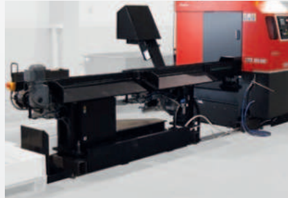
Plattenband mit Sortierweichen (Beispiel)
