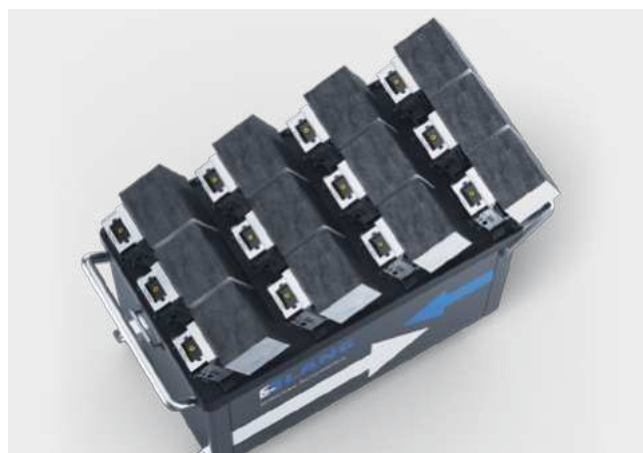
Chariot d'automatisation spéciale. Ici : 4 rangées de 3 positions pour 12 étaux avec une taille de pièce maximale de 205 × 203 × 150 mm.
