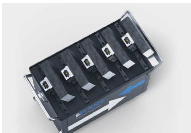
Chariot d'automatisation standard. Ici : 5 composants de 410 × 205 × 90 mm.
