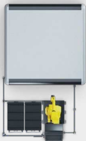
Beladung durch die Maschinentür
