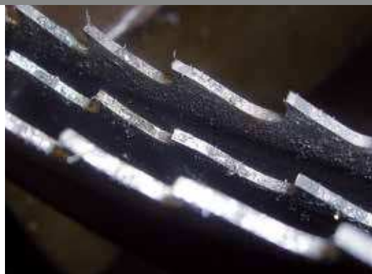
Spanen plakken aan de basis van de tand (koudglas)
