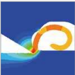
Nieuw tand ontwerp met spaanbreker
