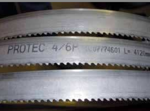
Bandzagen met zijdelingse beschadiging/slijtage
