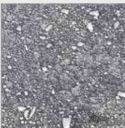
Foto van de structuur van het tandpunt materiaal (M42 HSS)
